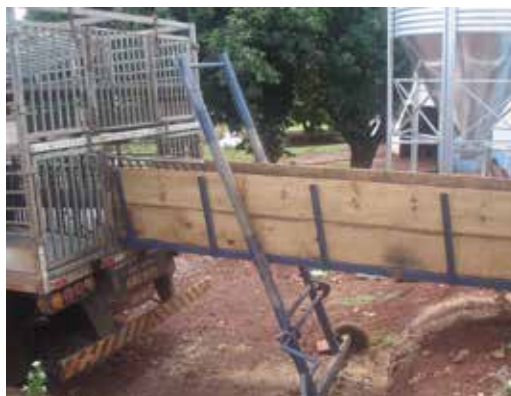
Figura 16. Embarcadouro com paredes fechadas e altura adequada
