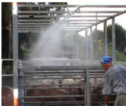
Figura 29. Embarque de suínos na granja – veículo com carroceria com piso hidráulico e sistema de aspersão com água.
