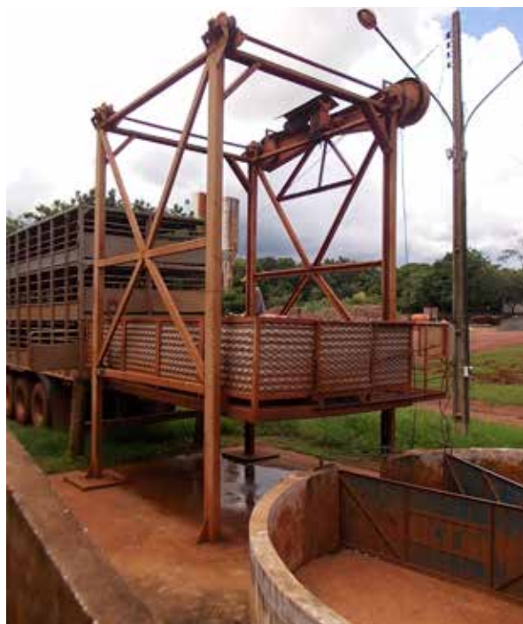
Foto 4 – Embarque dos suínos na granja, com utilização de plataforma móvel, facilita a condução dos animais em caminhões de três pisos
