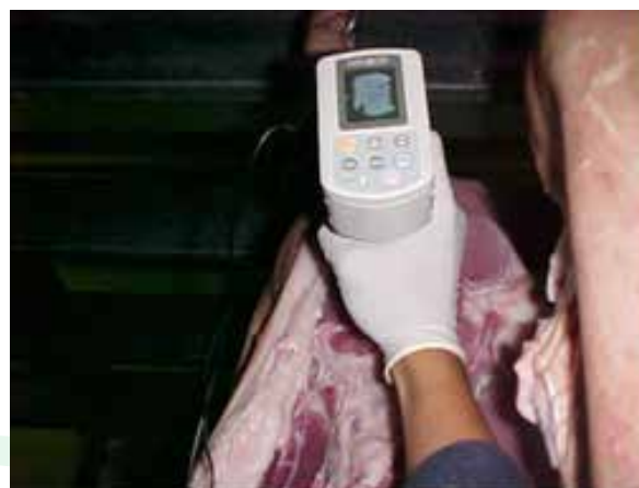
Foto 5 – Análise de cor pelo uso do colorímetro Minolta
