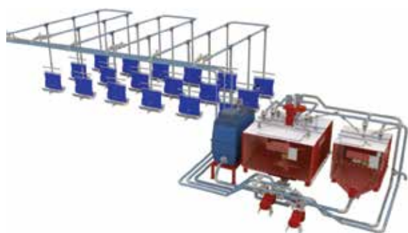
Figura 1 – Esquema de sistema de arração de dieta líquida
