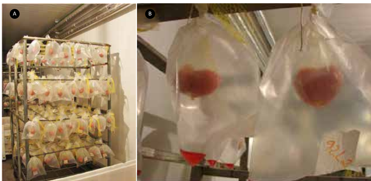
Foto 6 A e B – Método de exsudação por gravidade para medir a perda por gotejamento da carne suína
